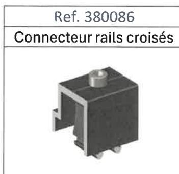
Cet élément permet l'assemblage de rails perpendiculairement afin d'opérer une installation en configuration paysage avec bridage sur les grands côtés, pour les installations avec crochets.
