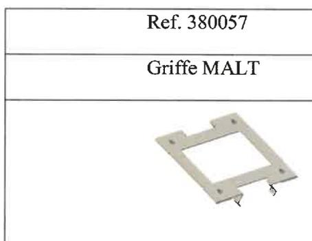
Cet élément permet d'effectuer la liaison équipotentielle des masses entre les cadres des modules photovoltaïques adjacents et les rails support. Il vient s'insérer dans la gorge supérieure du rail support, et vient griffer le cadre du module et le rail lors du bridage par les étriers.
